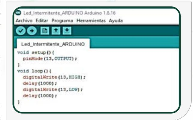
Figura 4. Programación para ejecutar en una tarjeta Arduino
