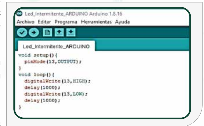
Figura 4. Programación para ejecutar en una tarjeta Arduino
